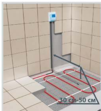
Схема укладки датчика температуры в гофрированной трубке
