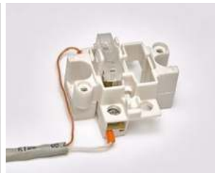
Фото 22. Подключение проводного выключателя
