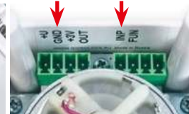
Фото 13. Клеммы подключения проводных датчиков — INP, GND
