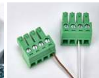
Фото 14. Подключение провода датчика к ответной части разъема
