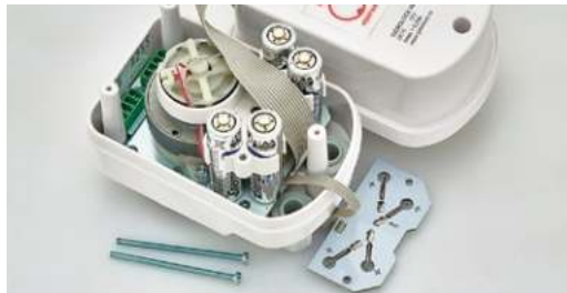
Фото 17. Контактная площадка снята, батарейки могут быть заменены
